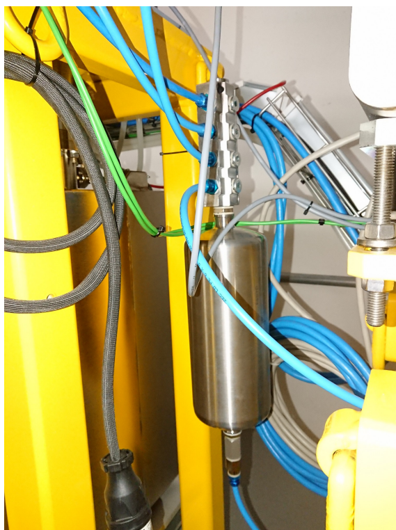
Fot. 3. Zbiorniczek buforowy z zaworem zwrotnym i lokalnym rozdzielaczem
